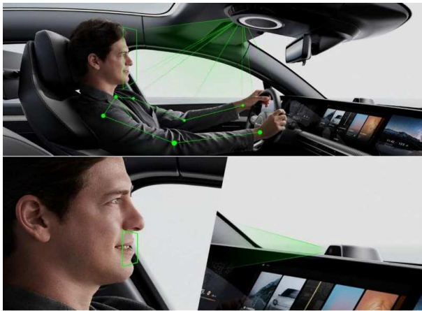
그림73 Vision-S 운전자 상태, 명령 인식 관련 센서
